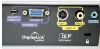
Nur wenige Anschlüsse finden sich auf der Rückseite des Projektors
