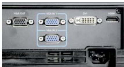
Analoge und digitale Anschlüsse hat der Acer-Projektor in ungewohnter Vielzahl zu bieten
